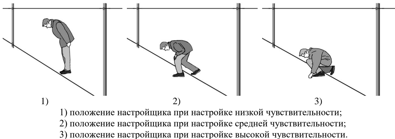
Рисунок 2.11 – Способы имитаций преодоления 30 при приземном варианте установки.
